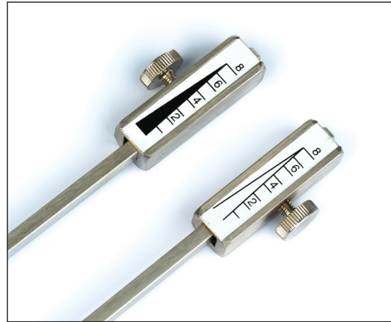
Figur 3. Rydel-Seiffer stämgaffel (128 /64 Hz). Stämgaffeln placeras vinkelrätt mot huden. När stämgaffelns vibrationer avklingningar skall den undersökte ange när denne inte längre känner några vibrationer. Avläs då på vilken nivå spetsen av den svarta triangeln ligger på den 9-gradig skalan.
