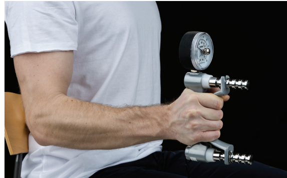
Figur 6. Mätning av handgreppsstyrka med hydraulisk handdynamometer Jamar®
